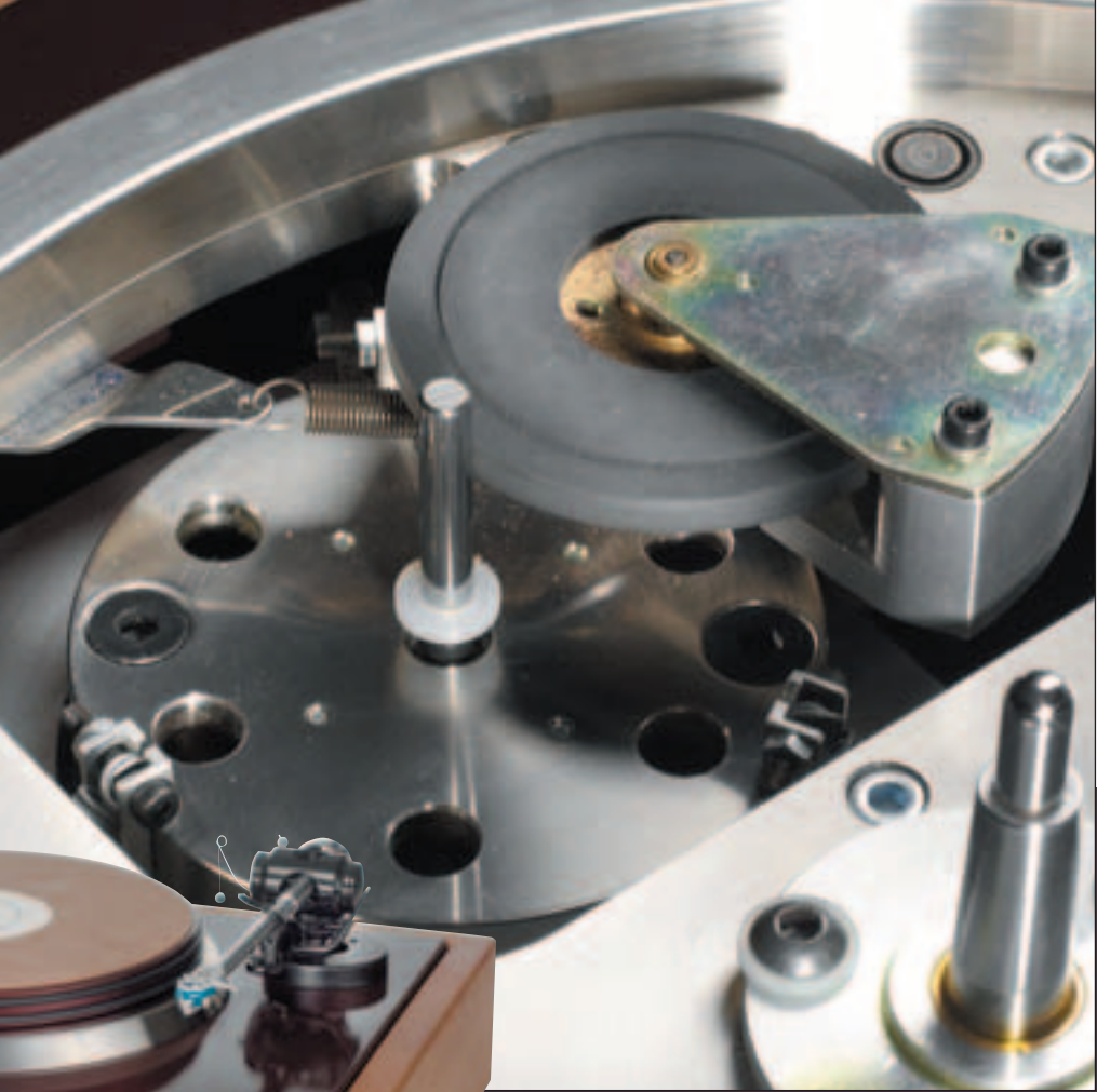
Unverwüstlich: Das Reibrad selbst läuft über Jahrzehnte völlig wartungsfrei. Deshalb verwendet Garrard zum Teil noch alte Exemplare, kann dieses Bauteil aber inzwischen selbst produzieren.
